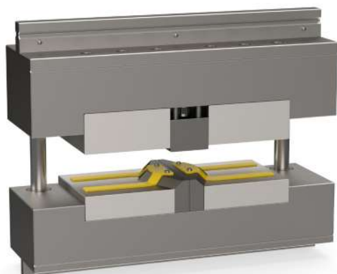
Z-Drukgereedschap in kolomframe en veergelagerde neerhouder - twee delen per slag
