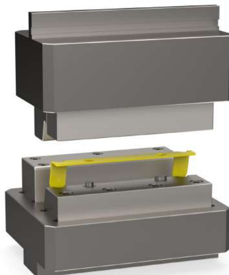
Verstevigingsribgereedschap voor twee ribben dicht aan de kantlijn, met neerhouder en zijdelingse houders in één slag
