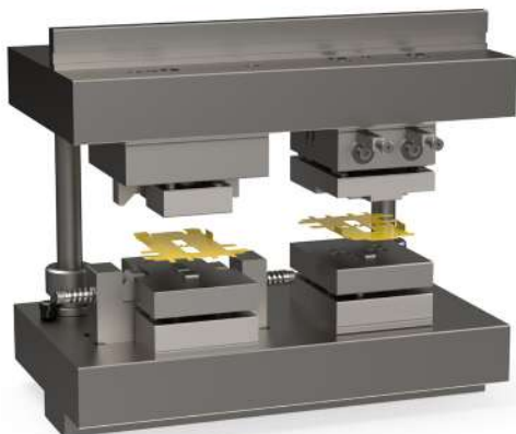
Station 1: Voorbuigen van verschillende buigingen op twee stations
