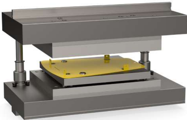
Speciaal gereedschap met kolomgeleiding voor het maken van vier interne 90° buigingen in één slag
