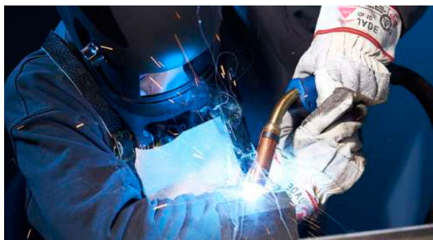
Oplassen van een beschadigd kantpersgereedschap (MAG procedure)
