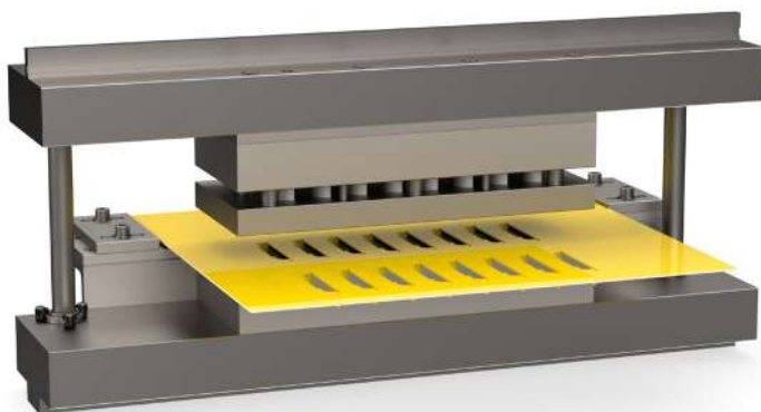
Kieuwgereedschap met geveerde neerhouder om de vervorming van het materiaal te verminderen
