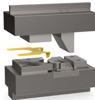
Station 2: Buiggereedschap voor het ombuigen van twee korte strippen aan de reeds gebogen poten, met behulp van beweegbare spie-wig houders
