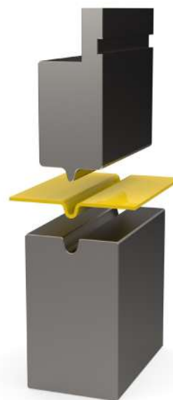
Gereedschap voor een kleine ronde versteving
