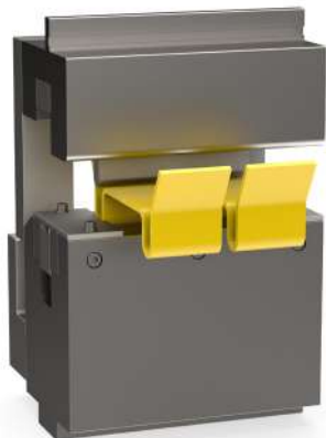
Station 1: U-Buiggereedschap met ruggeleiding en verende uitwerper
