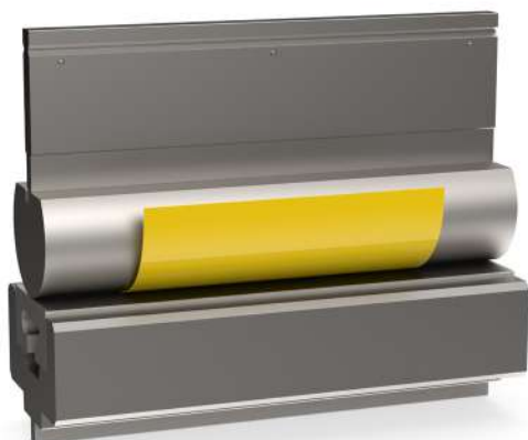
Station 1: Radiusgereedschap met PU-kussen voor het afdruk vrij afkanten van een radius van 180°
