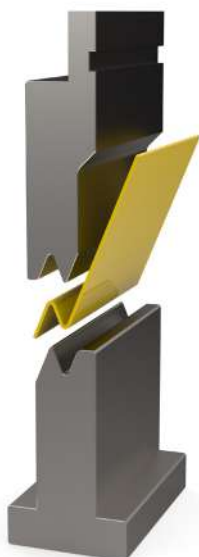
Z-buiggereedschap voor dun materiaal en scherpe hoeken
