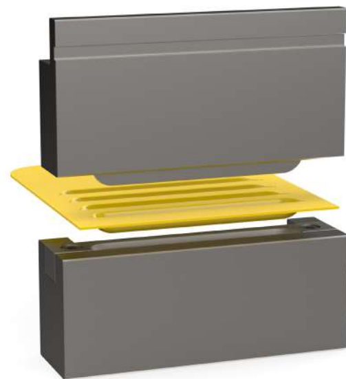
Kieuwgereedschap, eenvoudige uitvoering, zonder neerhouder
