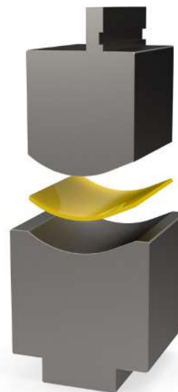
Radius doordrukgereedschap met recht doorlopende beenlengte
