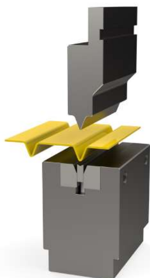
Gereedschap voor een V-vorm versteving met geveerde uitwerper
