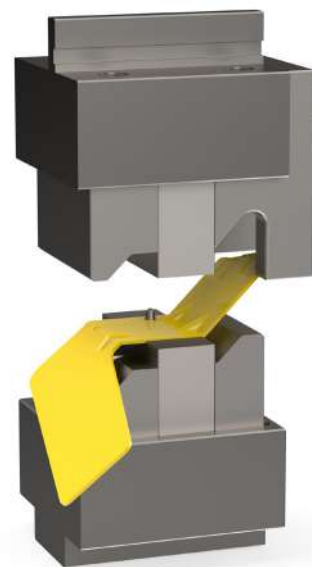
Speciaal gereedschap voor een Z-profiel, gevoerd en geveerd, voor vier verstevigingsribben in één slag
